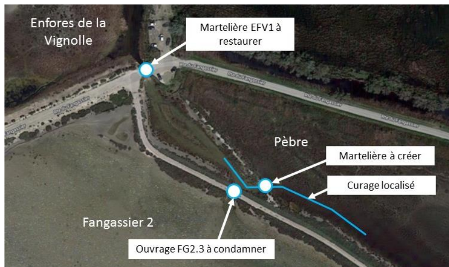
Travaux hydrauliques à étudier sur secteur Enfores / Pèbre
